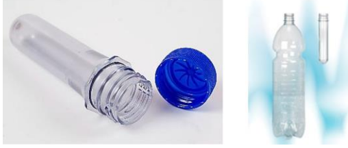
Şekil 2.8. Ham modelden şişirilmiş PET şişeye kadar plastik şişe üretimi ( https://commons.wikimedia.org/wiki/File:Plastic_bottle.jpg#/media/File:Plastic_bottle.jpg ; Nicole Gordine tarafından - Kendi çalışması, CC BY 3.0; https://commons.wikimedia.org/w/index.php?curid=16844093 ; https://commons.wikimedia.org/wiki/File:PETling.jpg#metadata )
