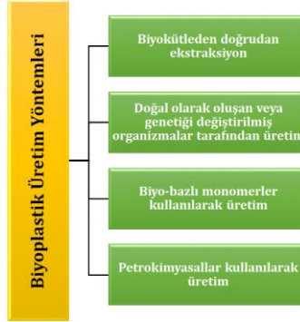
Şekil 3.2. Biyoplastik üretim yöntemlerinin şematik gösterimi
