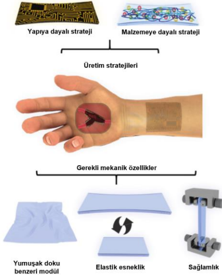
Şekil 6.4. İki üretim stratejisini ve gerekli mekanik özellikleri tasvir eden, gerilebilir - biyobozunur elektroniklerin çizimi. (Chen ve ark., 2022)'den çoğaltılmıştır.
