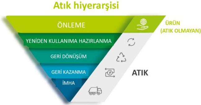
Şekil 3.9. Avrupa Atık Yönetimi Direktifine göre atık işleme hiyerarşisi ((European commission, 2020)’den yeniden basılmıştır).
